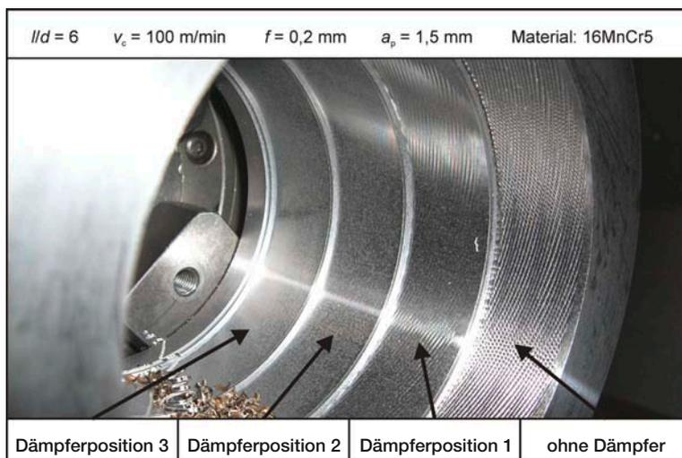
Bild: Oberflächengüte bei unterschiedlichen Dämpferpositionen
