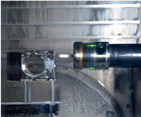
6 Closed-Loop-Inprozess-Messtechnik: Die hohen Anforderungen bezüglich der Form- und Lagetoleranzen werden auf den Grob-BAZ im Automatikbetrieb auch dank einer dem verschleißbedingten Trend entgegenwirkenden Korrektur im geschlossenen Mess- und Regelkreis erreicht © Hanser
