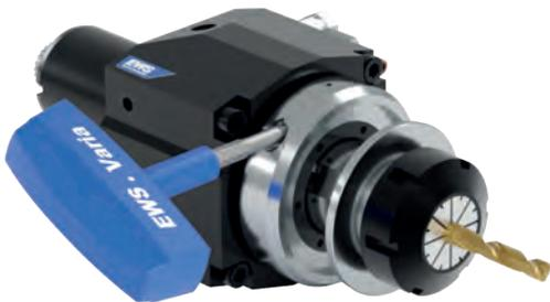
Spannen Sie den Einsatz durch drehen der Varia-Schraube (1) im Uhrzeigersinn und ziehen Sie diese mit 6Nm fest.
