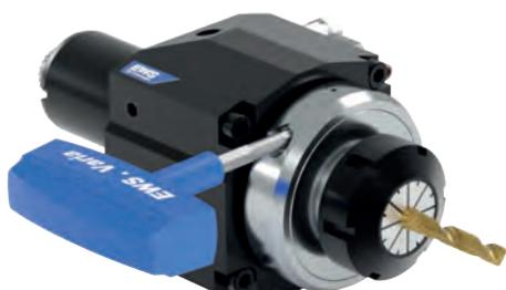
Öffnen Sie den Spanning durch Drehen der Varia-Schraube (1) gegen den Uhrzeigersinn. Das integrierte mechanische Auswerfsystem drückt den Einsatz von der Planfläche ab. Drehen Sie die Schraube leicht gegen den Anschlag.
