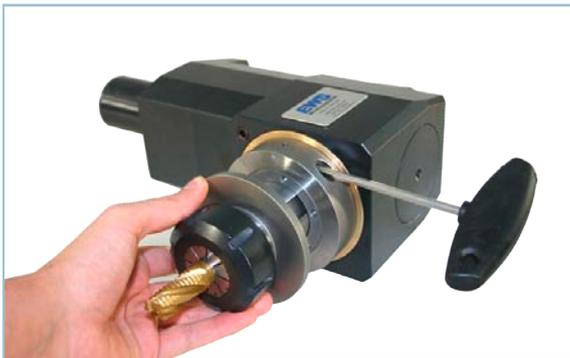
Danach können Sie den Einsatz entnehmen. Sprühen Sie Einsatz und Aufnahme nach der Reinigung mit einem Öl ein (Korrosionsschutz).
