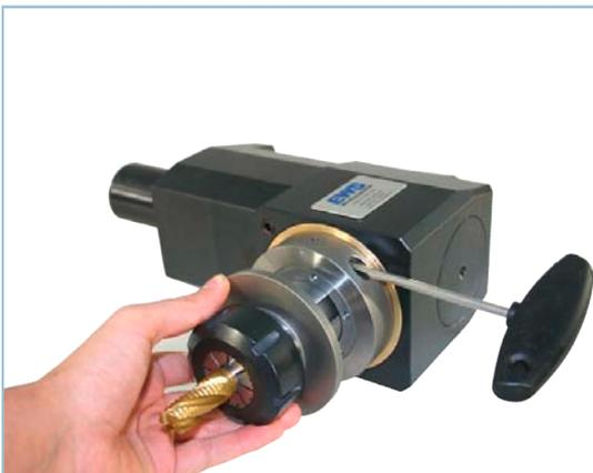
Spannen Sie den Einsatz durch drehen der Varia-Schraube (1) im Uhrzeigersinn und ziehen Sie diese mit **10Nm** fest. Hierzu empfehlen wir dringend den Drehmomentschlüssel DSV SW5 aus unserem Zubehörprogramm.
