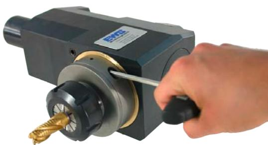
Das EWS-Varia-System gewährleistet den Plananzug des Einsatzes. Bitte überprüfen Sie dies durch Sichtkontrolle. Das Werkzeug ist nun einsatzbereit.
