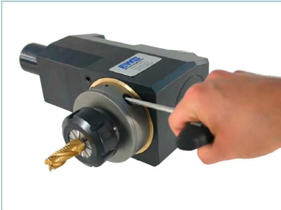
Öffnen Sie den Spannring durch Drehen der Varia-Schraube (1) gegen den Uhrzeigersinn. Das integrierte mechanische Auswerfsystem drückt den Einsatz von der Planfläche ab. Drehen Sie die Schraube leicht gegen den Anschlag.
